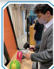
同學在測試含納米晶體的「彈性體長絲」性質
